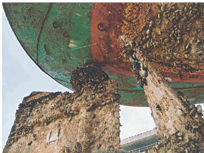
Slika 32. Obraštaj podvodnog dijela broskog trupa [10]
