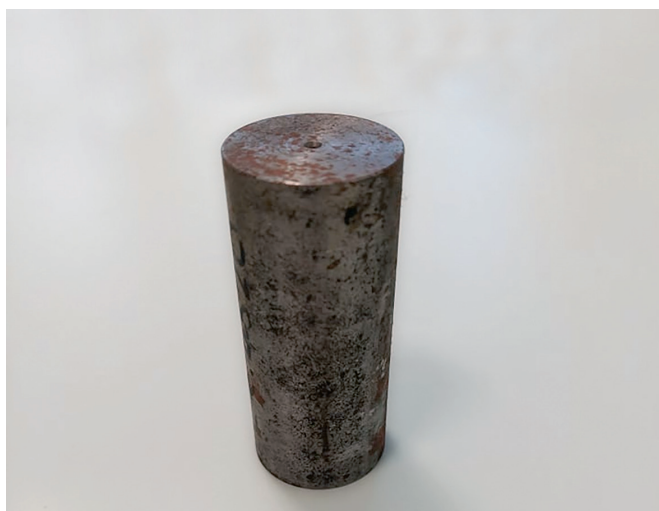
Slika 14. Čelik zahvaćen korozijom [9]
