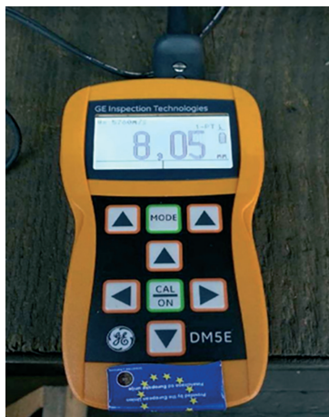
Slika 34. Uređaj za ultrazvučno mjerenje debljine stijenke [9]
