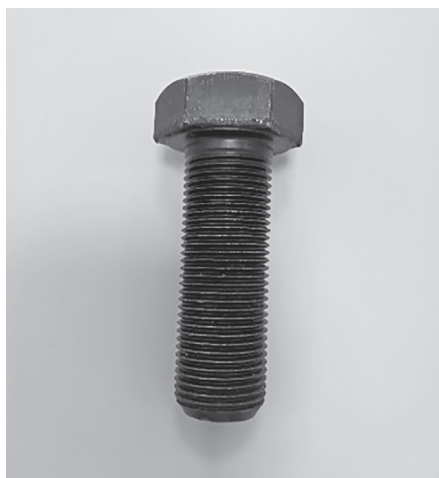
Slika 28. Vijak zaštićen bruniranjem [9]
